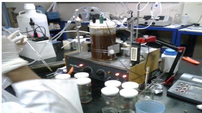
Figura 2. Biorreactor y sistemas auxiliares
