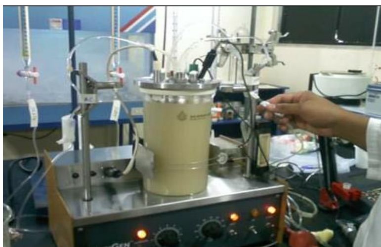
Figura 5. Biorreactor y sistemas auxiliares
